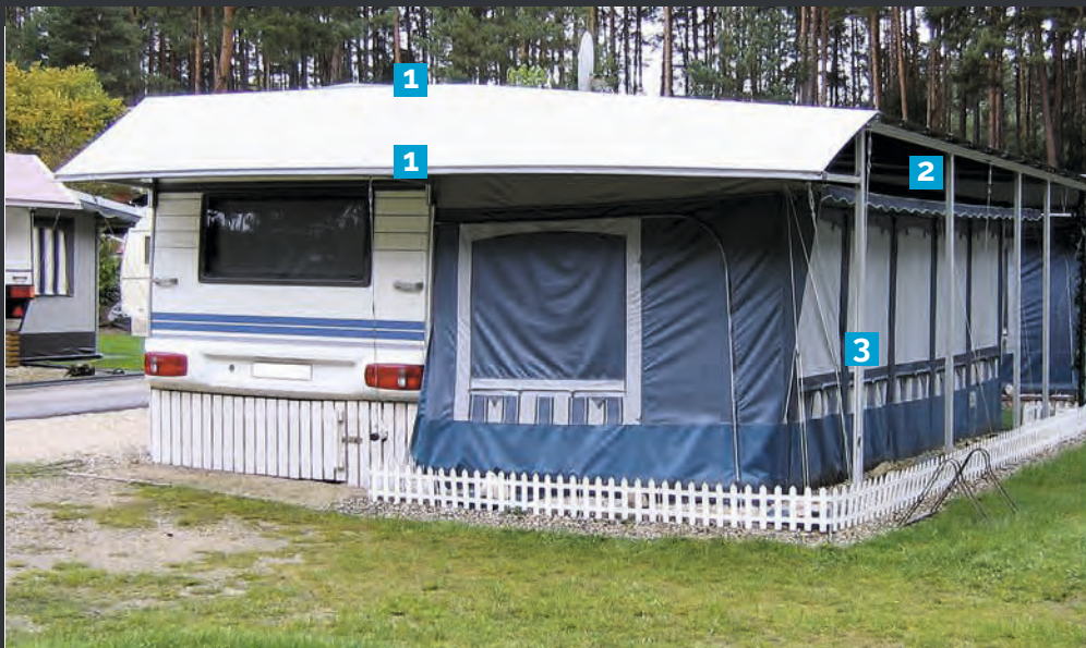
1 Alu-Spezial-Profile mit 2 durchgehendem Unterzug aus Alu-Spezial-Profil 65/40 mm 3 Stützen aus Alu-Spezial-Profil 65/40 mm, im Boden verankert, auch für Schneelasten geeignet.
